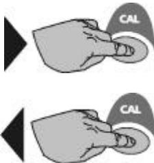
Einschalten der Spannungsversorgung während diese Taste gedrückt ist.
