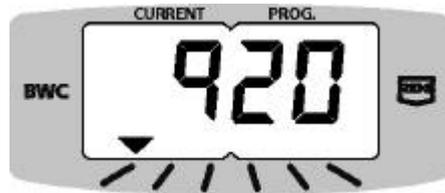
In der linken Displayhälfte wird die aktuelle Anzahl Wickelumdrehungen und in der rechten Displayhälfte die voreingestellte Soll-Anzahl angezeigt.
