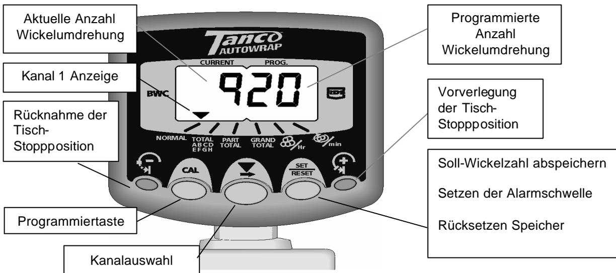
Kanal 1 **NORMAL** 'Normal' Anzeige (Aktuelle und Soll-Wickelumdrehungen werden angezeigt)
