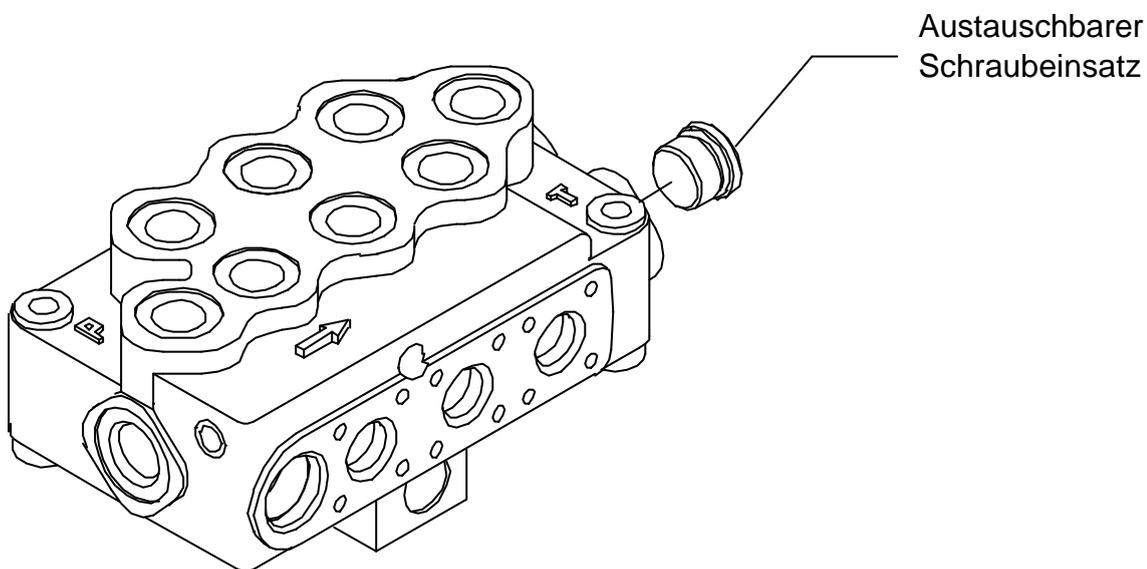
Falls Sie häufiger zwischen diesen Hydrauliksystemen wechseln müssen, können Sie einen Schraubeinsatz mit Gewindeinsatz verwenden (Ersatzteilnummer 1008050 – closed centre tap plug). Dieser Einsatz wird an der gleichen Stelle am Ventil eingesetzt.
